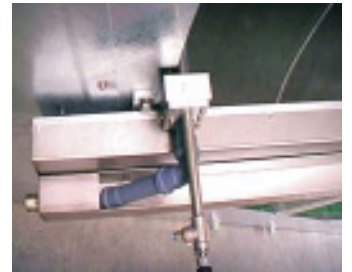
Bild unten: Reinigungseinrichtung zur automatischen Abreinigung der Speichermasse
