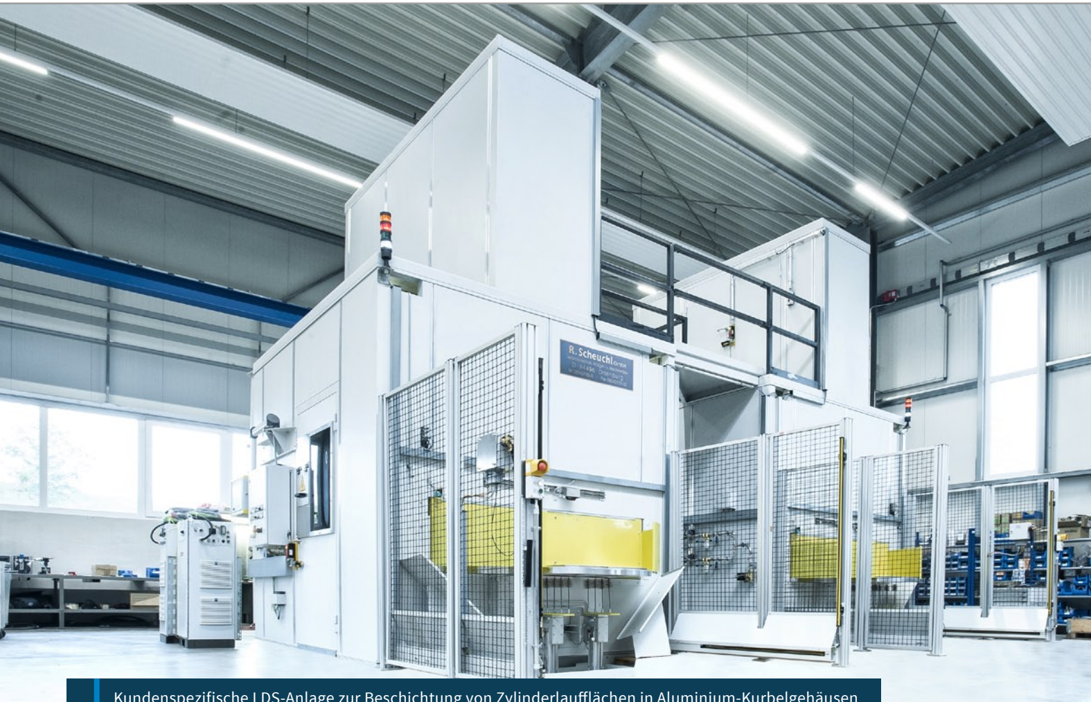
Kundenspezifische LDS-Anlage zur Beschichtung von Zylinderlaufflächen in Aluminium-Kurbelgehäusen
